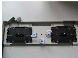
Bsp.: Bestückungsvariante 24x LC-Duplex mit 4 Spleißkassetten zu 12 Spleißen
